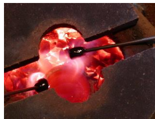
②約950℃まで温度を上げガラス原料を溶かす
